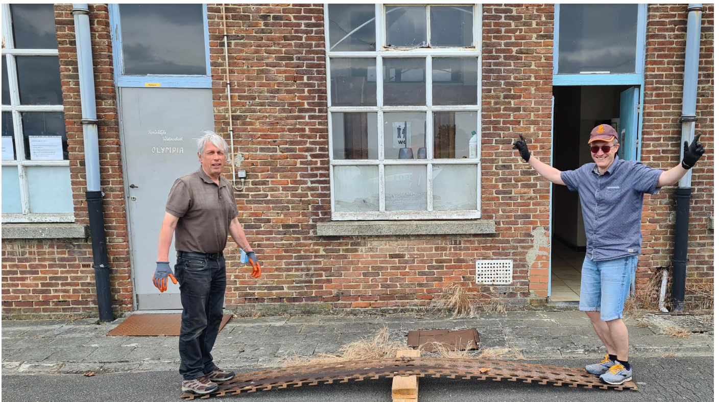
Op de wip... om de ijzeren platen weer vlak te krijgen.
