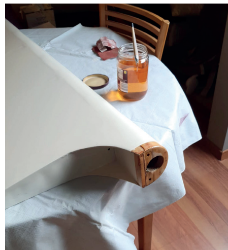
Jaarlijkse inspectie van het hoogteroer van de ASK13
