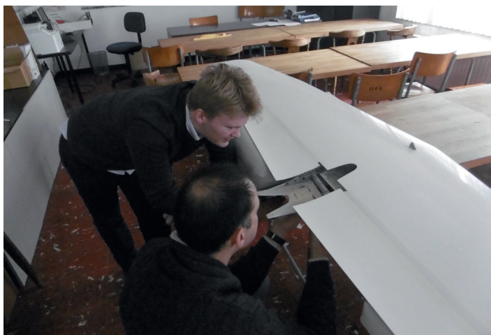
Nog een AD, op het hoogteroer van de Duo Discus Walter bij het winteronderhoud van de Ka8
