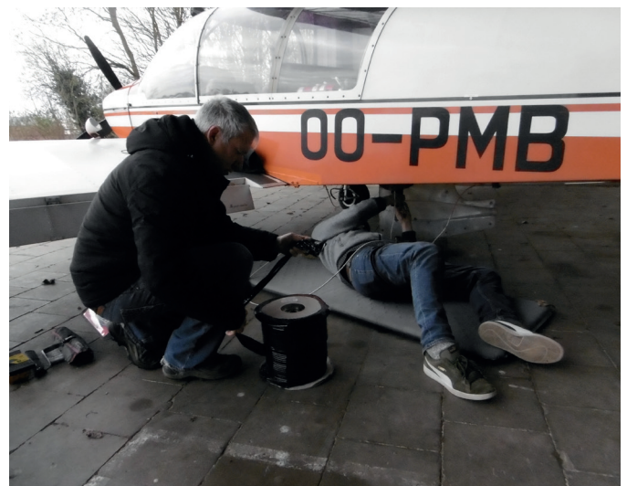
De sleepkabel van de PMB wordt vervangen
