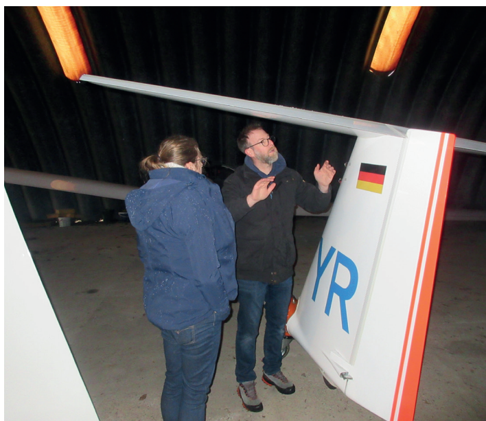
Controle van het hoogteroer van de Duo tijdens de ARC inspectie
