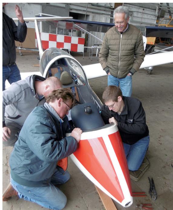
Het voetenstuur van de Twin werd vernieuwd om de speling weg te werken.
