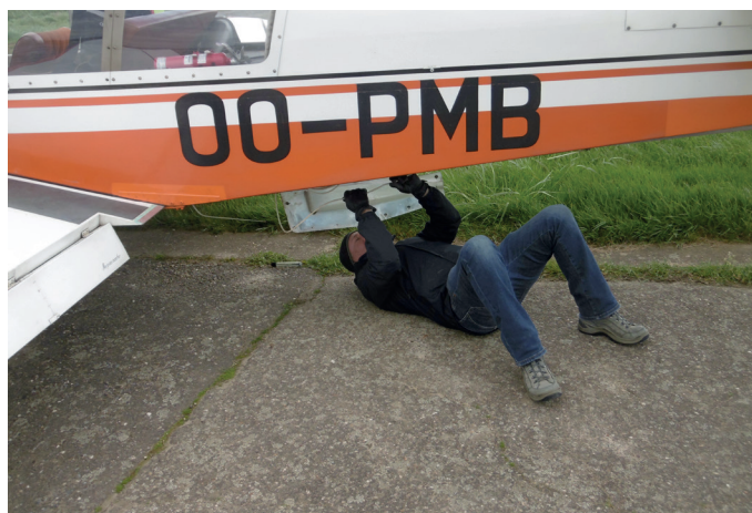
De band van de Robin werd vervangen, en een kink uit de kabel gehaald...
