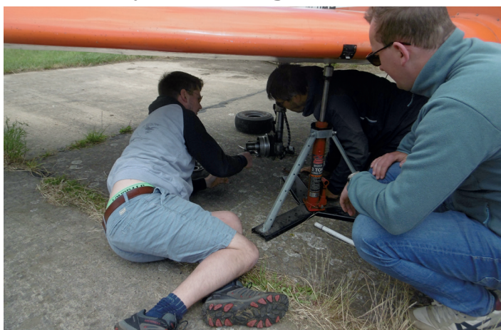
De band van de Robin werd vervangen, en een kink uit de kabel gehaald...
