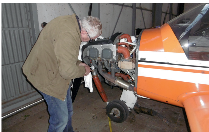
Technieker Raymond vervangt één van de cilinders en de uitlaat van de Robin
