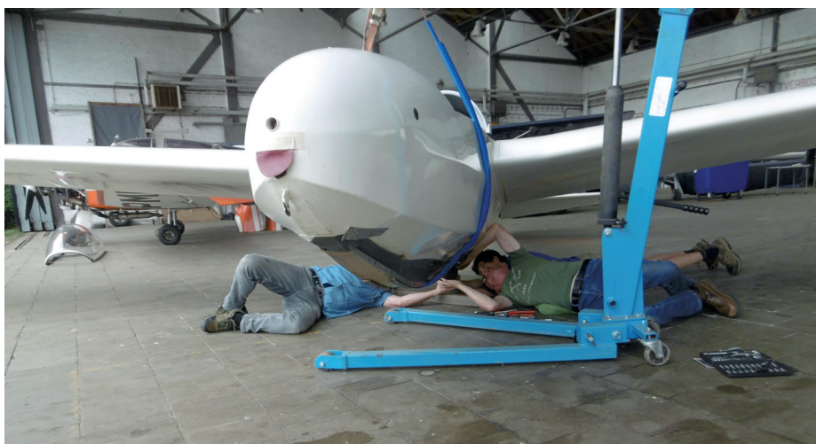
De rem van de D6988 wordt hersteld na remproblemen
