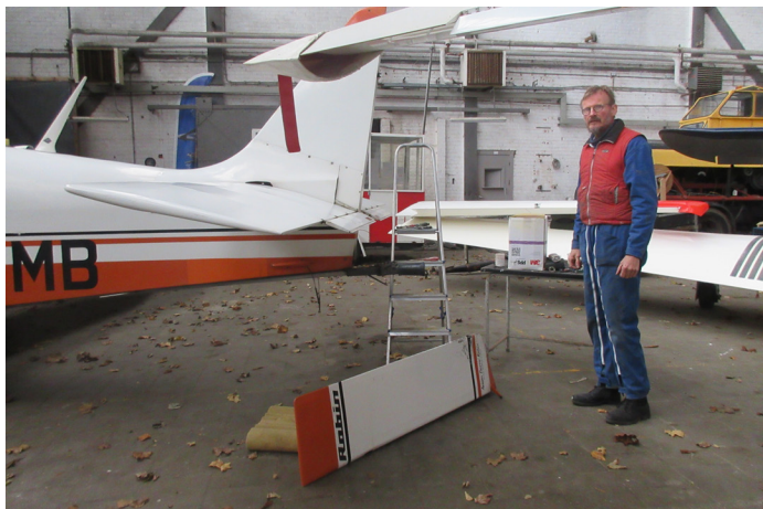
Danny demonteert het richtingsroer van de Robin voor herstellingswerken
